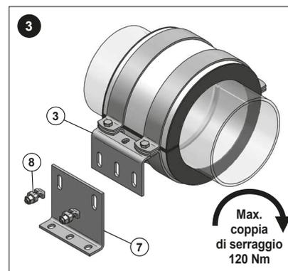
3.) Collegare le squadrette alle squadrette di base (7) utilizzando le viti con testa a martello (8). Serrare le viti con una coppia di serraggio di 120 Nm. Attaccare il tutto alla struttura di supporto sottostante (binario a C, Profilo Centum).
