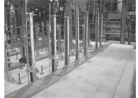
Fig. 2: Sistema di misurazione del comportamento dei carichi del sistema nel forno
