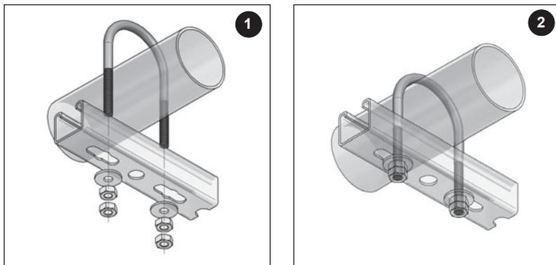
1. Posizionare l'U-Bolt sul tubo in acciaio ubicato sopra al binario di montaggio.
